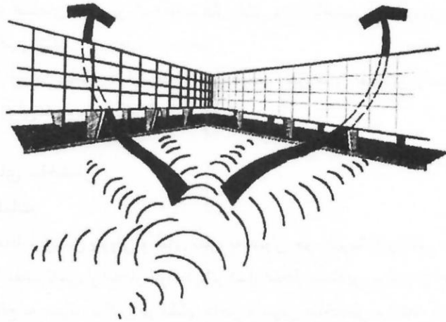
شکل ۲-۲۱-۵- تخلیه موج انفجار از پیلوت باز
