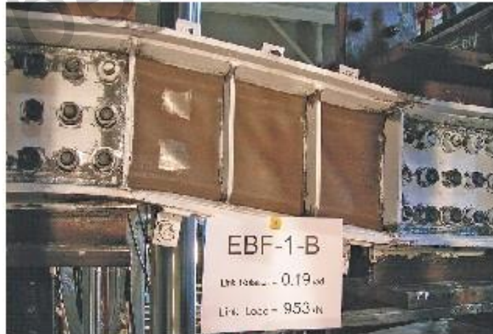
سخت کننده برای جلوگیری از کمانش قطری
